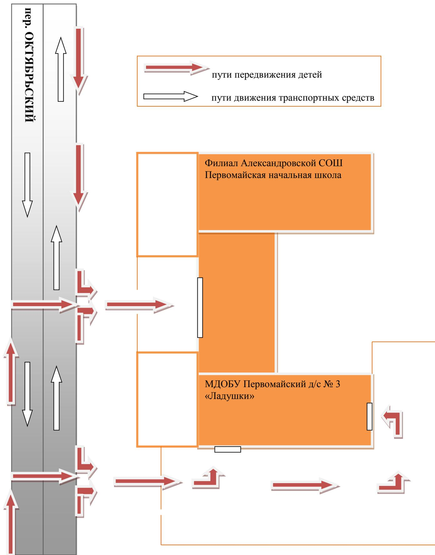
**1.3. Схема организации дорожного движения в непосредственной близости МДОБУ «№ 3 с размещением соответствующих технических средств, маршруты движения детей и расположение парковочных мест**
